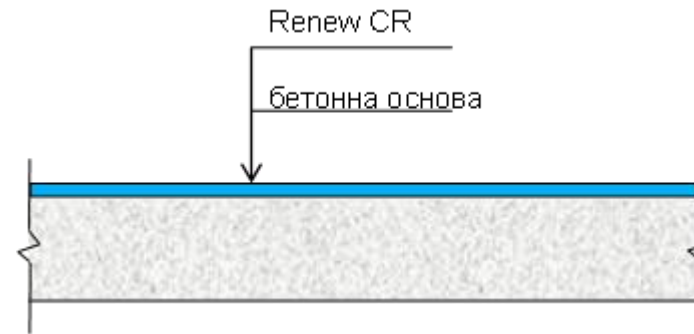
Рисунок I-14-2. Стандартна схема улаштування бетонного покриття відкритих складів, рамп, бетонних сходів та пандусів
